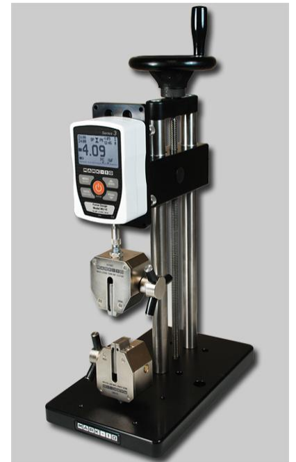
圖例：ES20 測試台 和 G1061 楔形夾具
